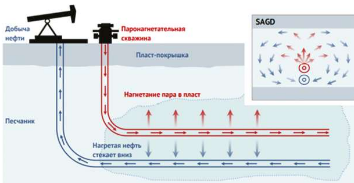
Рисунок 1. Схема метода парогравитационного дренажа
